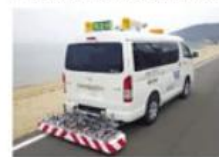
③ 地下探査車 路面を走行しながら地下の空洞や埋設物を調査（ウエスコ提供）
